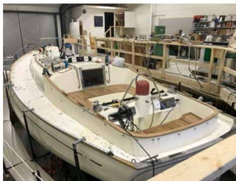
Nytt underlag, tvättat med rödsprit och klart för läggning. Sittbrunnen klar för nätning.
