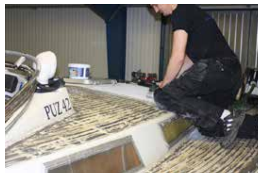
2. Däckets renslipas och görs klart för mallning av nytt teakdäck.
